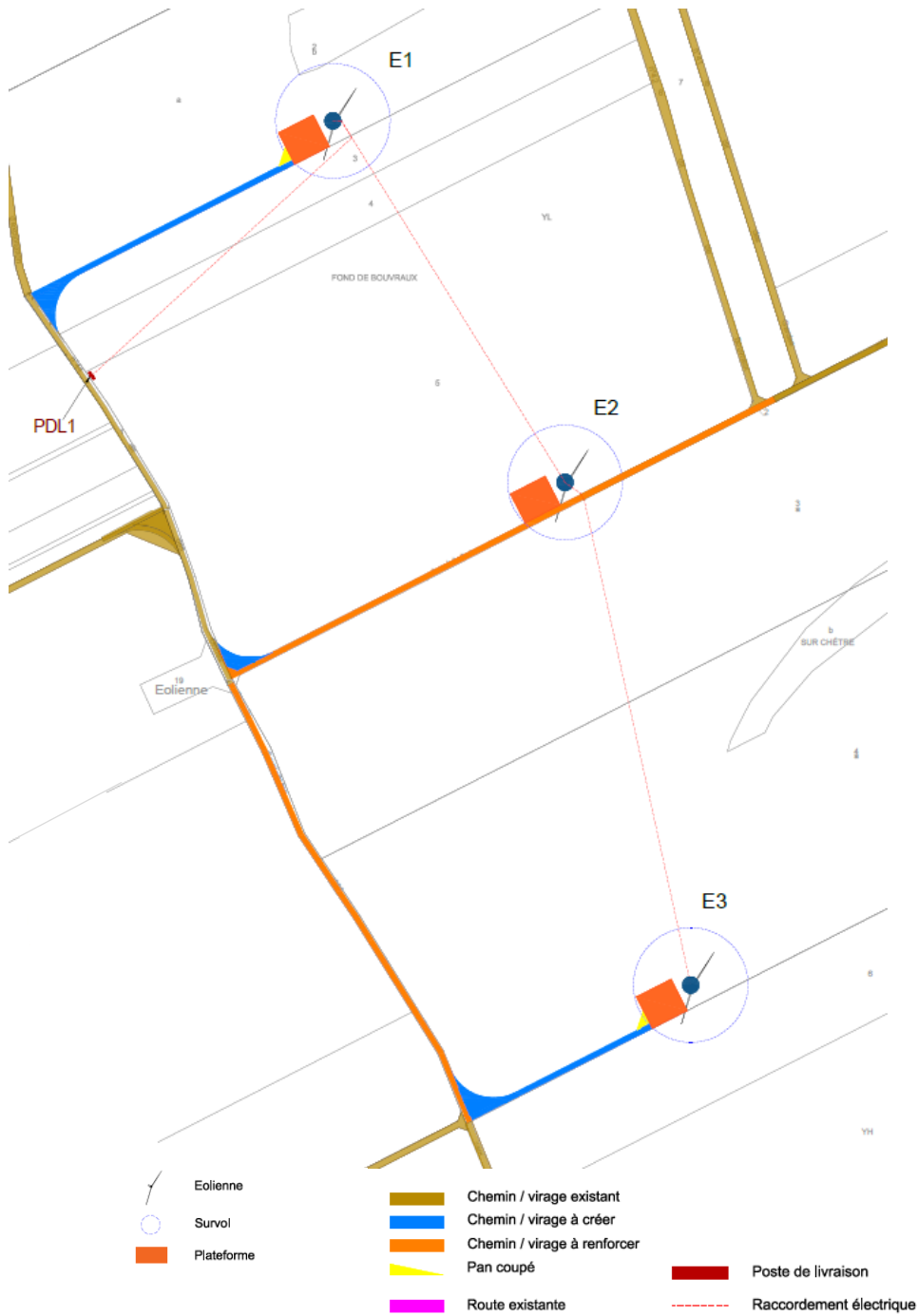
Carte 3 : Vue cadastrale du projet éolien de Bronne - Sans Souci – (Eoliennes : E1, E2 et E3 – modèle NORDEX N177)
